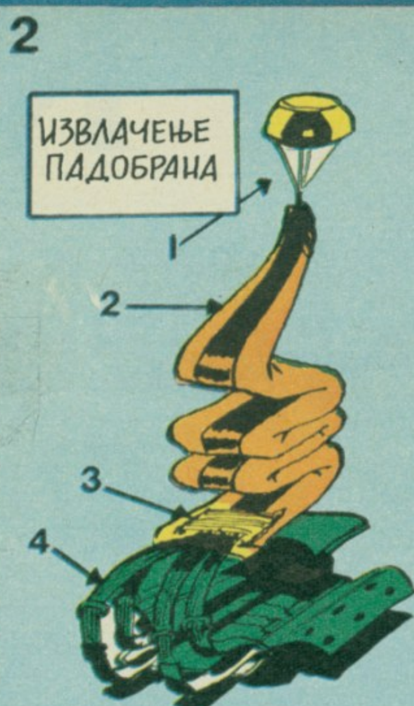
ИЗВЛАЧЕЊЕ ПАДОБРАНА 1) пилот-падобранчић који из- влачи куполу са конопцима; 2) навлака са куполом; 3) конопци; 4) ранец са системом веза.
