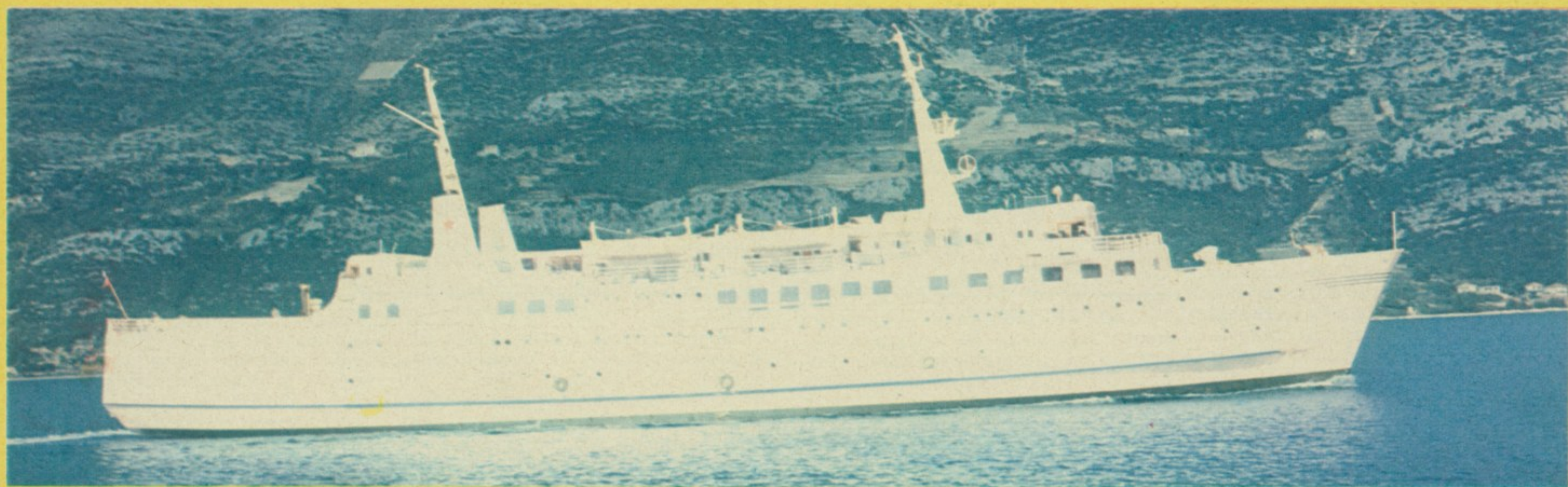
„ИЛИРИЈА“ — Моторни трајект који лети превози путнике и возила између Задра и Анконе, у Италији, а зими плови на линији Ријека — Дубровник — Бари. Саграђен је 1963. године у Папенбургу. Носивост 2027 БРТ, погонска снага 4000 КС, економска брзина 15 чворова на час, максималан газ 3,80 метара. Трајект има 45 чланова посаде, може да прими 650 путника и 80 возила. На њему се налазе 43 путничка лежаја.
