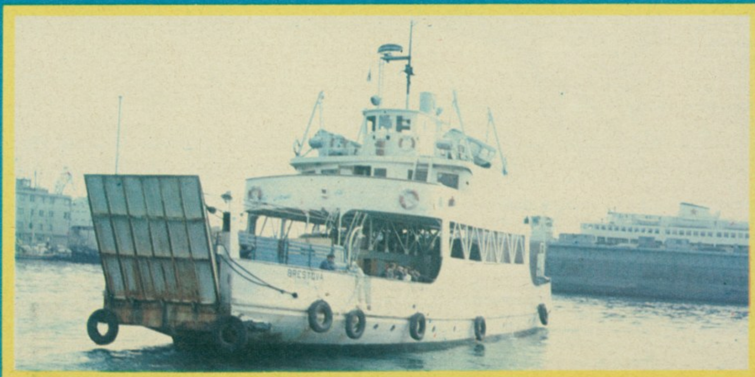
„КАЛМАР“ — Моторни трајект (раније је носио назив „Брестово“), саграђен 1951. године у Калмарварију, у Мађарској. Плови између копна и острва на краћим линијама. Носивост 399 БРТ, погонска снага 1050 КС, економска брзина 10 чворова на час, максималан газ 3,30 метара. Трајект има 9 чланова посаде а може да прими 150 путника и 30 возила.
