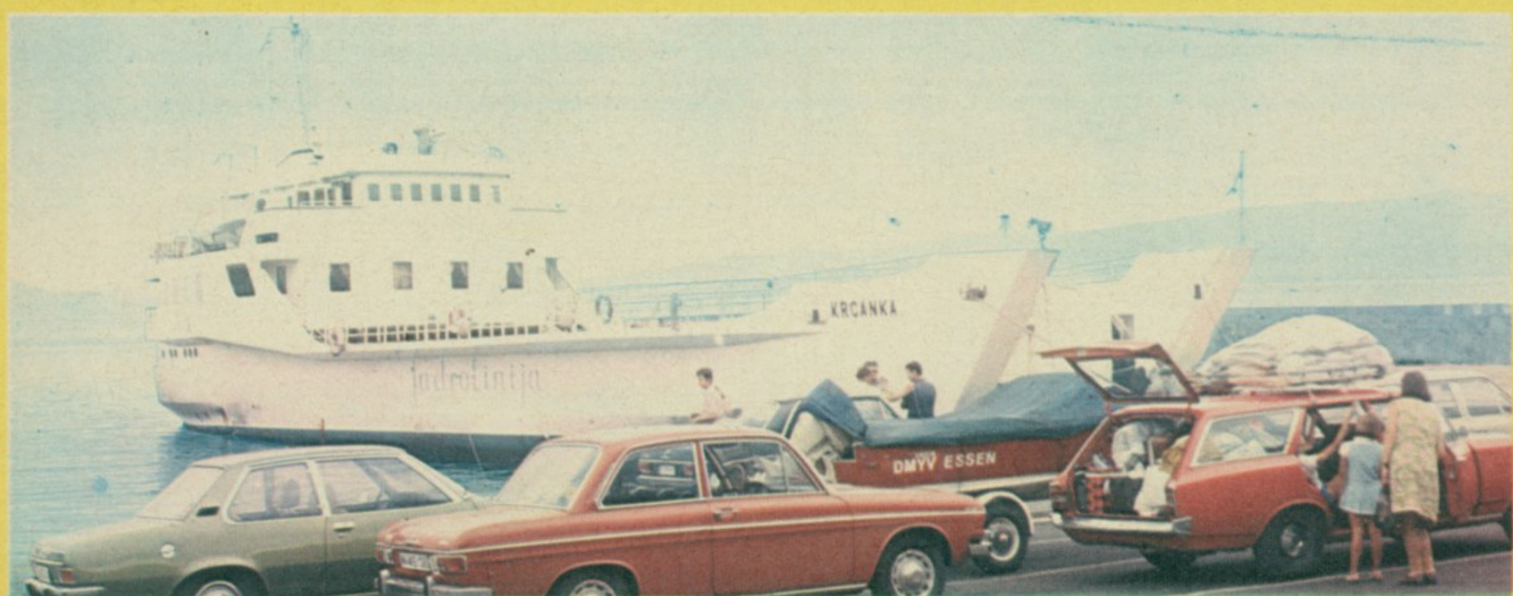
„КРЧАНКА“ — Моторни трајект саграђен 1970. године у Краљевици. Плови између лука на копну и кварнерских острва. Носивост 411 БРТ, погонска снага 980 КС, економска брзина 10 чворова на час, максималан газ 1,8 метара. Трајект има 9 чланова посаде. Може да прими 200 путника и 34 возила.
