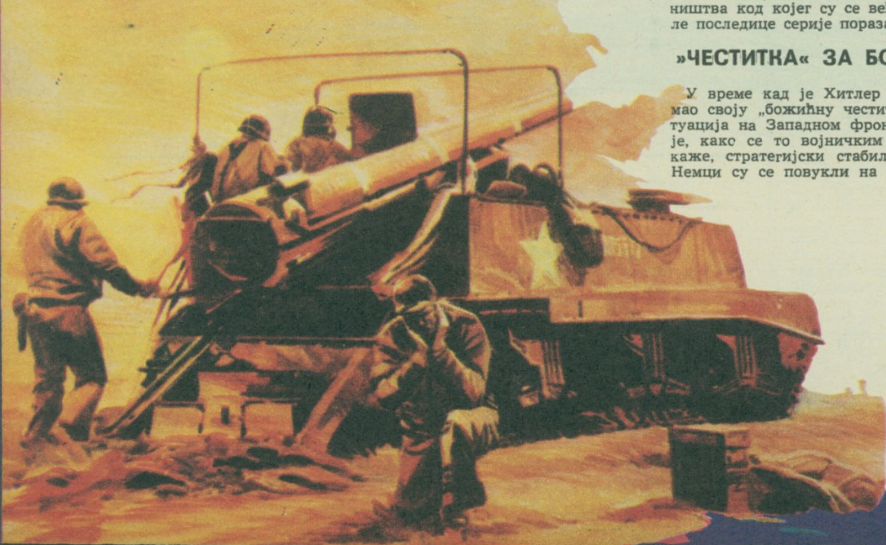
Амерички самоходни топ, иначе познатији под називом »Дугачки Том«, монтиран је на шасију тенка типа »шерман«.
