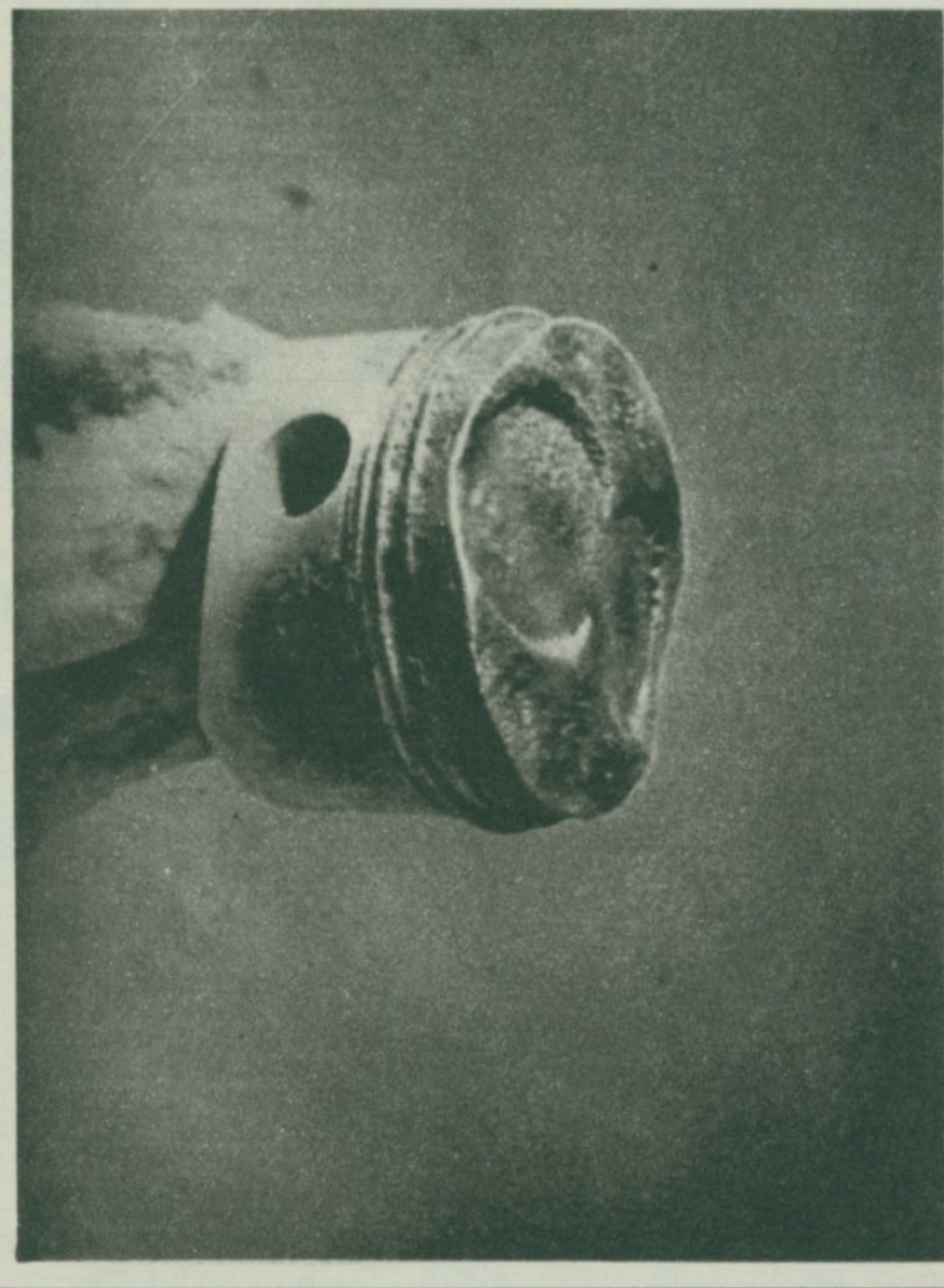
Погубан утицај детонантног сагоревања горива на цилиндар авионског мотора!
