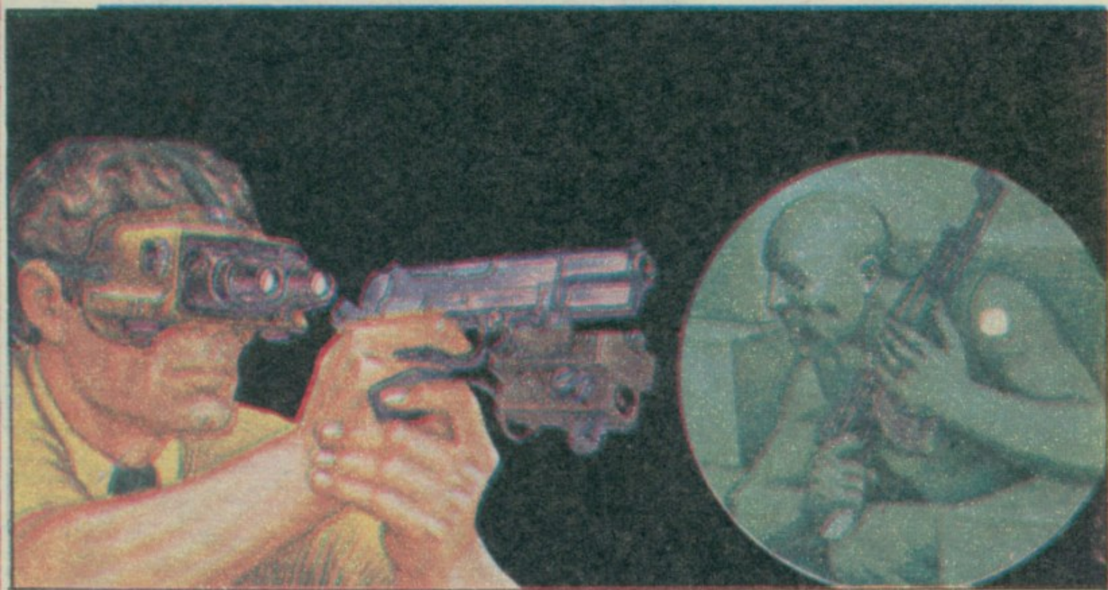
Појачање светла у комбинацији са ласером слабе снаге AIM-1 причвршћеним за оружје. Ласерски зрак невидљив је голим оком. Стрелац га пак усмерава по вољи. Траг зрака види се кроз ноћни двоглед као бела пилула (на слици) и тако обезбеђује сигуран погодак.
