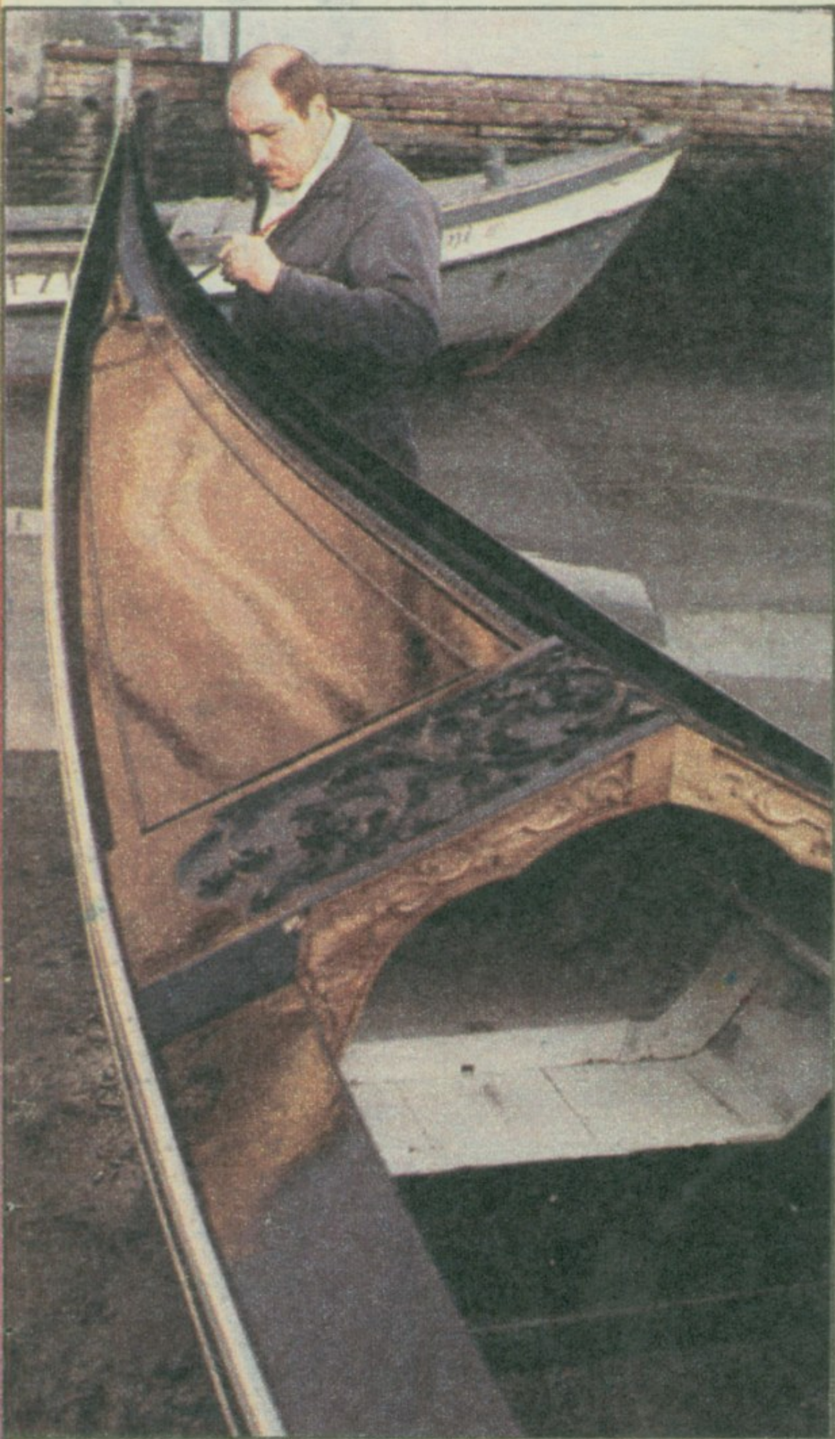
После сати и сати рада, још увек постоји нешто што треба на гондоли поправити. Роберто користи малу четкицу да би „попунио“ ситне шупљине које није ухватила црна боја
