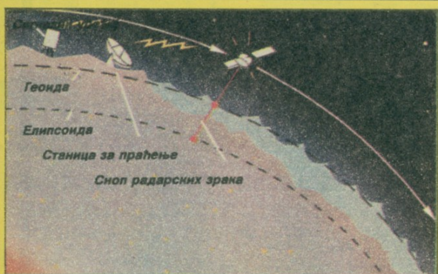
Сателити повезани са Земљом мере стварну висину површине мора (геоида) изнад референтне равни, такозване „елипсоиде“
