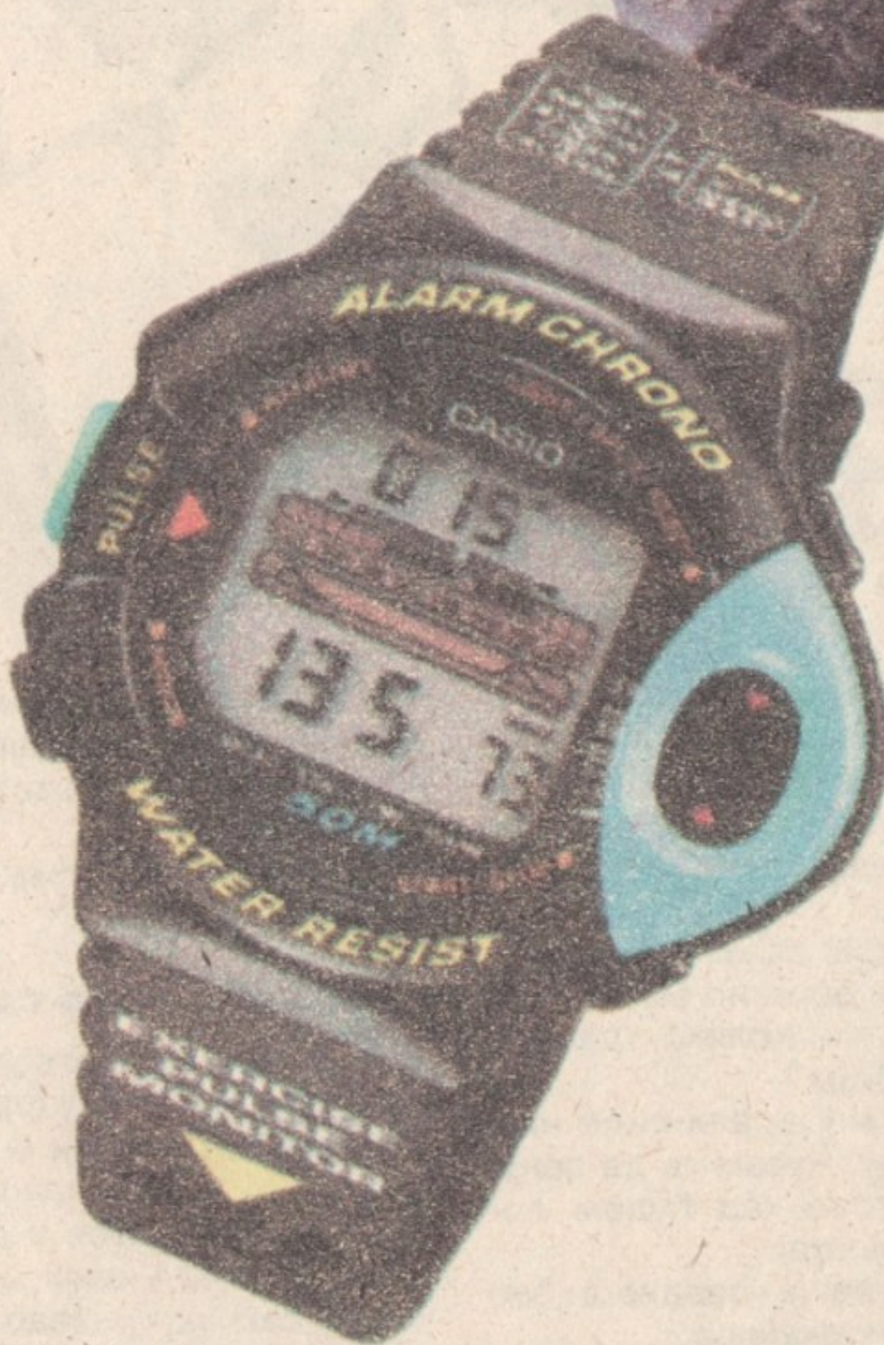
Сат с мерачем пулса. Сензор мери концентрацију крви у врху прста, помоћу инфрацрвеног зрака који продире кроз кожу, и на тај начин одређује пулс.
