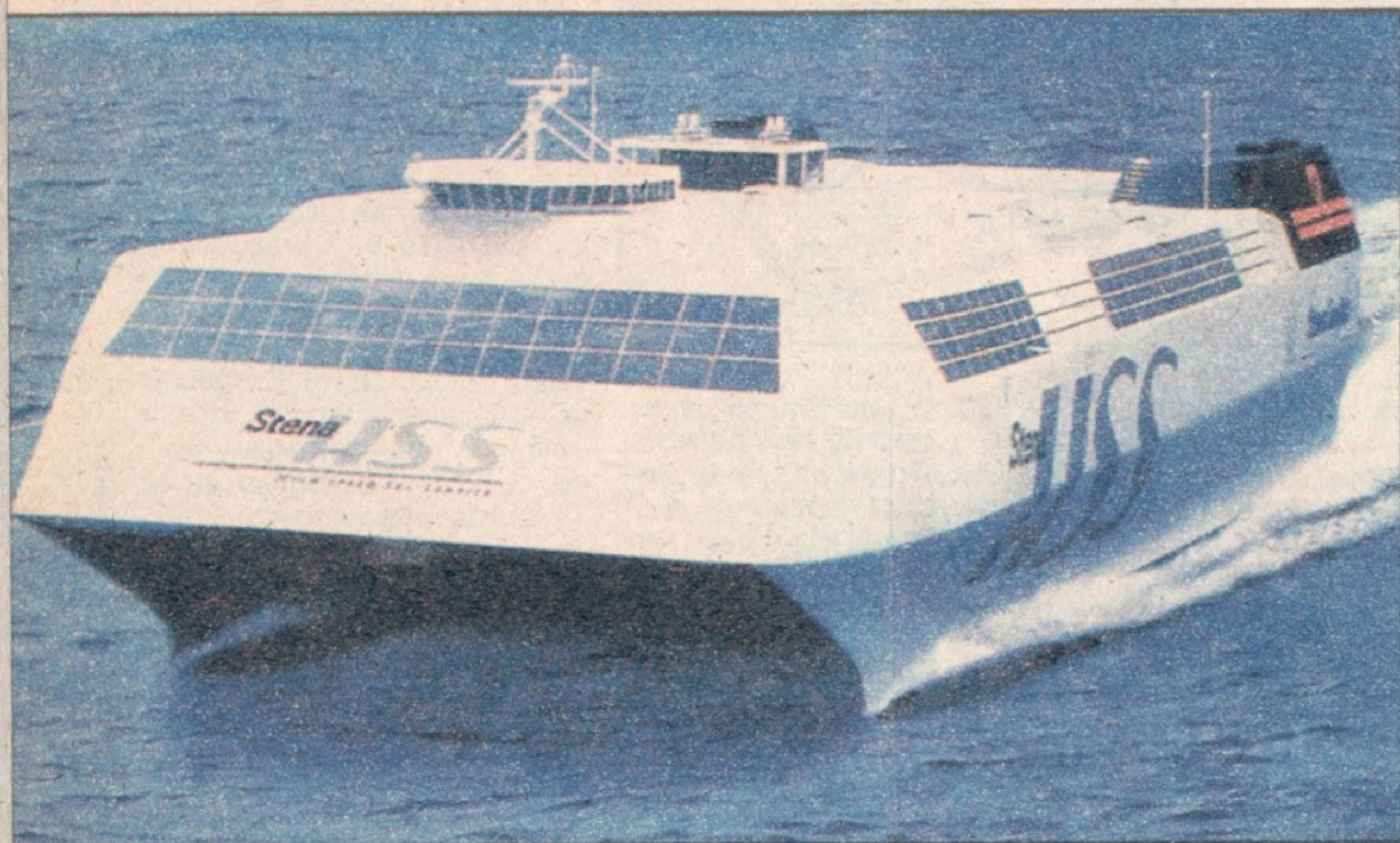
Шведски катамаран „Stena HSS” (124 метра дугачак, 40 метара широк) чије четири турбине развијају 100 хиљада коњских снага.
