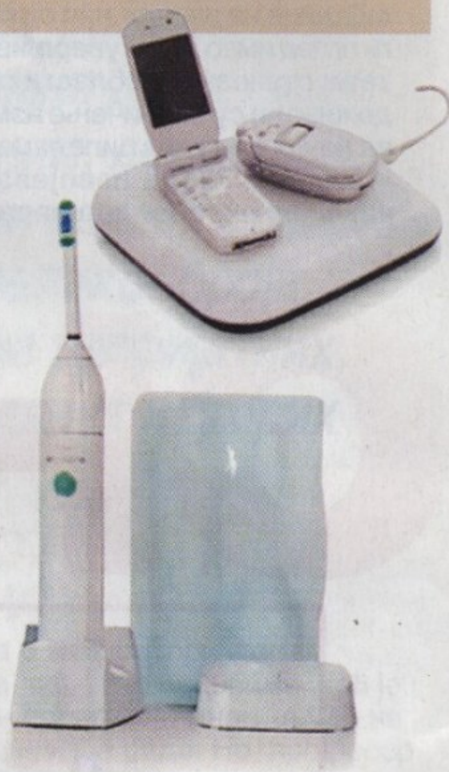
Два примера бежичног пуњења: за мобилне телефоне и четкице за зубе
